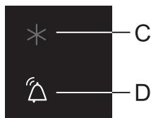
Når apparatet tilsluttes for første gang, eller hvis temperaturen i apparatet er for høj (over +13 °C), lyder der periodisk en akustisk alarm, og symbolet **D** blinker.
