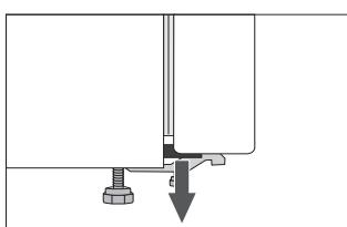
Distanshållare sitter i hörnen på dörrarna. Ta bort dem och sätt in medföljande pluggar i hålen (gäller endast vissa modeller).
