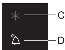
Jos lämpötila laitteen sisällä on liian korkea, kuuluu hälytsääni (katkonainen ääni) ja symboli **D** vilkkuu.
