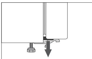
Suojakappaleet on asennettu ovien kulmiin. Irrota ne ja laita toimitukseen sisältyvät tulpat paikoilleen (vain joissakin malleissa).
